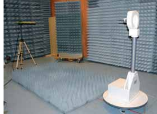
Messaufbau im abgeschirmten Absorberraum, bestehend aus dreidimensionaler Positioniereinheit mit Messobjekt (rechts) und Messantenne (links)
