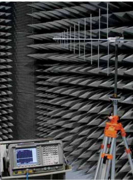
Begehbare reflexionsarme Abschirmkabine Anechoic chamber
