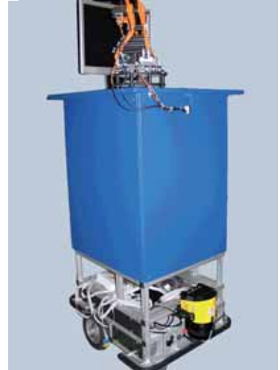
Ergänzung der Profibot-Plattform mit einem Abstandssensor und einem Plattform-Aufbau für Präsentationszwecke
