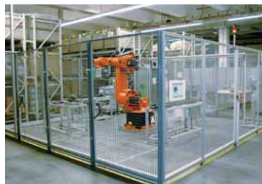
Roboterzelle mit zwei Förderbändern Robot cell with two conveyor bands
